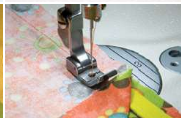
TE XI 5020 Stopka do wszywania kedry 3,2 mm lewa
