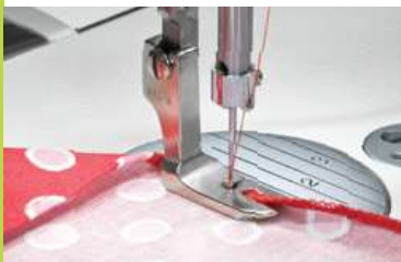
TE XI 5007 Stopka zwijająca 1/8" (3,2 cm)
