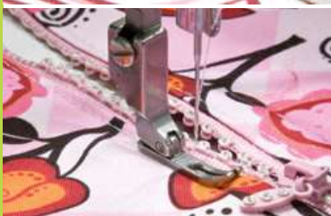
TE XI 5011 Stopka do wszywania zamków z wąskimi płozami
