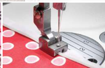
TE XI 5012 Stopka do wszywania zamków krytych
